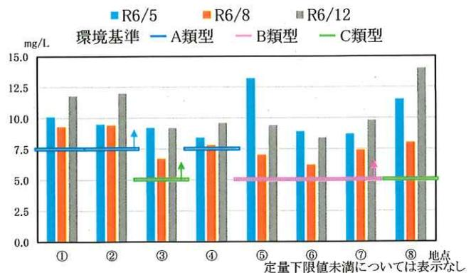
DOは水に溶けている酸素量のことで、河川が汚染されるとDOが低くなり、魚類等の水棲生物が棲めなくなる。今年度の結果は、5月が8.4mg/L～13.2mg/L、8月が6.2mg/L～9.4mg/L、12月が8.4mg/L～14.0mg/Lの範囲にあり、特に問題ない値であった。
