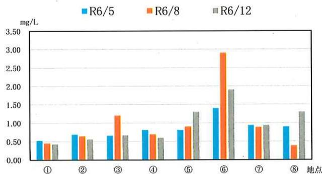
全窒素は全リンと共に水質の富栄養化成分として極めて重要な項目である。植物プランクトンや水生植物の異常発生の原因となる成分であり、異常繁茂で水中のDOが減少し、魚類等に大きな被害を与える事がある。基準としては農業(水稲)用水基準(1mg/L以下)がある。
